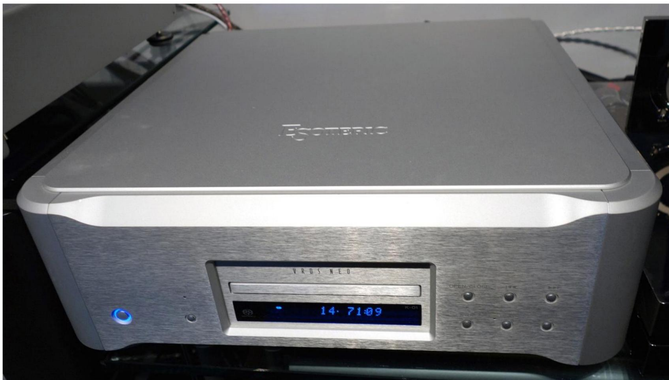
Le transport VRDS-NEO de Esoteric utilise un moteur triphasé sans balai à aimant néodyme et un système de lecture de haute précision permettant de lire CD et SACD.
